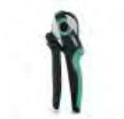
Presszange, für unisolierte und isolierte Aderendhülsen DIN 46228 Teil 1 und 4 von 0,14 mm<sup>2</sup> ... 10 mm<sup>2</sup>, ebenfalls für TWIN Aderendhülsen bis 2 x 4 mm<sup>2</sup>, automatische Querschnittsanpassung, seitliche Einführung, ausgestattet mit Fallschutz
