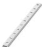
Zackband flach, Streifen, weiß, beschriftet, längs bedruckt: fortlaufende Zahlen 1-10, 11-20 usw. bis 991-1000, Montageart: verrasten in flacher Schildchennut, für Klemmenbreite: 10 mm, Schriftfeldgröße: 5,15 x 10 mm
