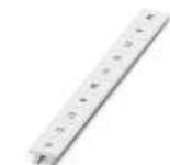
Marker für Klemmen, Streifen, weiß, beschriftet, beschriftbar mit: CMS-P1-PLOTTER, längs: L1, L2, L3, N, PE, L1, L2, L3, N, PE, Montageart: verrasten in hoher Schildchennut, für Klemmenbreite: 10,2 mm, Schriftfeldgröße: 10,15 x 10,5 mm
