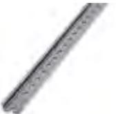
Tragschiene gelocht, Standardprofil, Breite: 35 mm, Höhe: 7,5 mm, nach EN 60715, Material: Stahl, verzinkt, weißpassiviert, Länge: 2000 mm, Farbe: weiß
