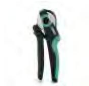
Presszange, für unisolierte und isolierte Aderendhülsen DIN 46228 Teil 1 und 4 von 0,14 mm<sup>2</sup> ... 6 mm<sup>2</sup>, ebenfalls für TWIN Aderendhülsen bis 2 x 4 mm<sup>2</sup>, automatische Querschnittsanpassung, seitliche Einführung, ausgestattet mit Fallschutz
