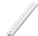
Zackband, Streifen, weiß, beschriftet, beschriftbar mit: CMS-P1-PLOTTER, quer bedruckt: fortlaufende Zahlen 1-10, 11-20 usw. bis 991-1000, Montageart: verrasten in hoher Schildchennut, für Klemmenbreite: 10,2 mm, Schriftfeldgröße: 10,15 x 10,5 mm
