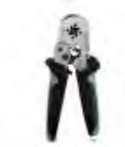
Presszange, für Aderendhülsen ohne Isolierkragen nach DIN 46228 Teil 1 und Aderendhülsen mit Isolierkragen nach DIN 46228 Teil 4, 0,14 mm<sup>2</sup> ... 10 mm<sup>2</sup>, Zwangssperre entriegelbar, seitliche Einführung
