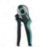
Presszange, für unisolierte und isolierte Aderendhülsen DIN 46228 Teil 1 und 4 von 0,14 mm<sup>2</sup> ... 10 mm<sup>2</sup>, ebenfalls für TWIN Aderendhülsen bis 2 x 4 mm<sup>2</sup>, automatische Querschnittsanpassung, seitliche Einführung, ausgestattet mit Fallschutz
