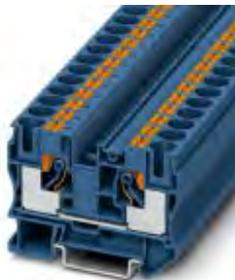
Durchgangsklemme, Nennspannung: 1000 V, Nennstrom: 57 A, Anschlussart: Push-in-Anschluss, Anzahl der Anschlüsse: 2, Querschnitt: 0,5 mm<sup>2</sup> - 16 mm<sup>2</sup>, AWG: 20 - 6, Breite: 10,2 mm, Höhe: 49,5 mm, Farbe: blau, Montageart: NS 35/7,5, NS 35/15
