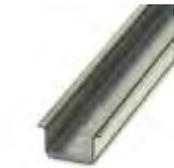
Tragschiene ungelocht, Standardprofil, Breite: 35 mm, Höhe: 15 mm, ähnlich EN 60715, Material: Stahl, verzinkt, dickschichtpassiviert, Länge: 2000 mm, Farbe: silberfarben
