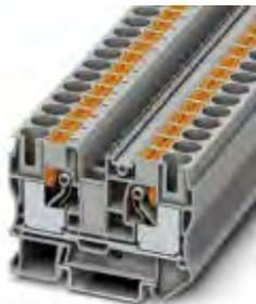
Durchgangsklemme, Nennspannung: 1000 V, Nennstrom: 57 A, Anschlussart: Push-in-Anschluss, Push-in-Anschluss, Anzahl der Anschlüsse: 2, Querschnitt: 0,5 mm<sup>2</sup> - 16 mm<sup>2</sup>, AWG: 20 - 6, Breite: 10,2 mm, Höhe: 49,5 mm, Farbe: grau, Montageart: NS 35/7,5, NS 35/15
