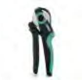
Presszange, für unisolierte und isolierte Aderendhülsen DIN 46228 Teil 1 und 4 von 0,14 mm<sup>2</sup> ... 10 mm<sup>2</sup>, ebenfalls für TWIN Aderendhülsen bis 2 x 4 mm<sup>2</sup>, automatische Querschnittsanpassung, seitliche Einführung, ausgestattet mit Fallschutz
