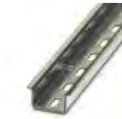
Tragschiene gelocht, Standardprofil, Breite: 35 mm, Höhe: 15 mm, ähnlich EN 60715, Material: Stahl, verzinkt, dickschichtpassiviert, Länge: 2000 mm, Farbe: silberfarben
