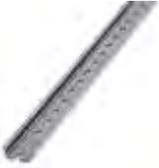
Tragschiene gelocht, Standardprofil, Breite: 35 mm, Höhe: 7,5 mm, nach EN 60715, Material: Stahl, verzinkt, weißpassiviert, Länge: 2000 mm, Farbe: weiß
