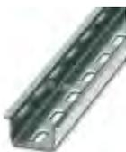
Tragschiene gelocht, Standardprofil, Breite: 35 mm, Höhe: 15 mm, ähnlich EN 60715, Material: Stahl, verzinkt, weißpassiviert, Länge: 2000 mm, Farbe: weiß
