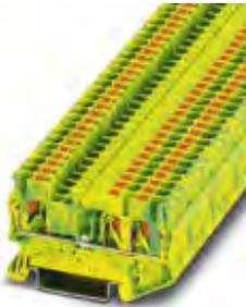
Schutzleiter-Reihenklemme, Anschlussart: Push-in-Anschluss, Anzahl der Anschlüsse: 3, Querschnitt: 0,14 mm<sup>2</sup> - 4 mm<sup>2</sup>, AWG: 26 - 12, Breite: 5,2 mm, Höhe: 35,2 mm, Farbe: grün-gelb, Montageart: NS 35/7,5, NS 35/15
