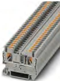
Durchgangsklemme, Nennspannung: 800 V, Nennstrom: 24 A, Anschlussart: Push-in-Anschluss, Anzahl der Anschlüsse: 2, Polzahl: 1, Querschnitt: 0,14 mm<sup>2</sup> - 4 mm<sup>2</sup>, AWG: 26 - 12, Breite: 5,2 mm, Höhe: 35,3 mm, Farbe: grau, Montageart: NS 35/7,5, NS 35/15
