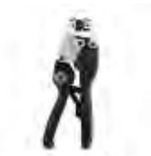
Presszange, für Aderendhülsen ohne Isolierkragen nach DIN 46228 Teil 1 und Aderendhülsen mit Isolierkragen nach DIN 46228 Teil 4, 0,25 mm<sup>2</sup> ... 6 mm<sup>2</sup>, seitliche Einführung, Trapez-Crimp
