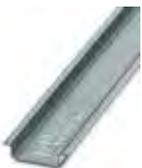
Tragschiene ungelocht, Standardprofil, Breite: 35 mm, Höhe: 7,5 mm, nach EN 60715, Material: Stahl, verzinkt, weißpassiviert, Länge: 2000 mm, Farbe: weiß
