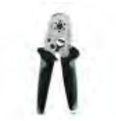
Presszange, für Aderendhülsen ohne Isolierkragen nach DIN 46228 Teil 1 und Aderendhülsen mit Isolierkragen nach DIN 46228 Teil 4, 0,14 mm<sup>2</sup> ... 6 mm<sup>2</sup>, Zwangssperre entriegelbar, seitliche Einführung
