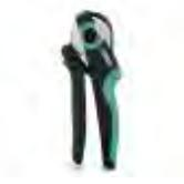
Presszange, für unisolierte und isolierte Aderendhülsen DIN 46228 Teil 1 und 4 von 0,14 mm<sup>2</sup> ... 6 mm<sup>2</sup>, ebenfalls für TWIN Aderendhülsen bis 2 x 4 mm<sup>2</sup>, automatische Querschnittsanpassung, seitliche Einführung, ausgestattet mit Fallschutz
