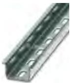
Tragschiene gelocht, Standardprofil, Breite: 35 mm, Höhe: 15 mm, ähnlich EN 60715, Material: Stahl, verzinkt, weißpassiviert, Länge: 2000 mm, Farbe: weiß
