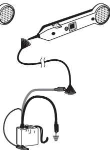
Figure 2b. Rastreamento de cabos
