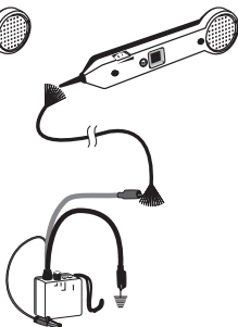
Figura 2b. Traccia del cavo
