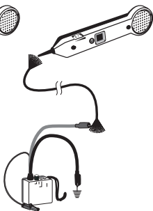
Figure 2b. Localisation d'un câble
