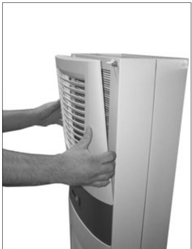
Fig. 42: Remove the upper louvred grille
