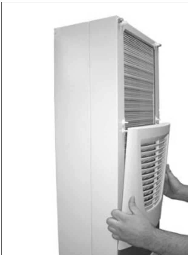
Fig. 63: Remove the upper louvred grille (3)
